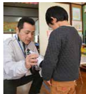
サーベイメーターによる体表面汚染検査(写真右)と車載式WBCによる内部被ばく検査(写真左)の様子。希望者が対象で、昨年は約1200人が受検しました
